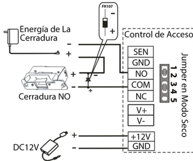
**Modo Seco:** Fuente de alimentación externa para cerradura NC
